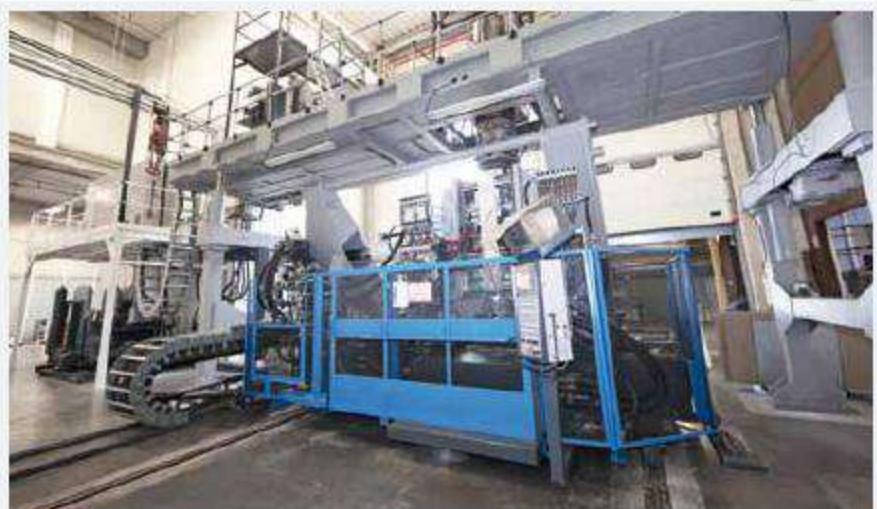
Инъекционно-литевой автомат, используемый для производства этих игрушек, каждые 72 секунды изготавливает новую стенку для домика.
